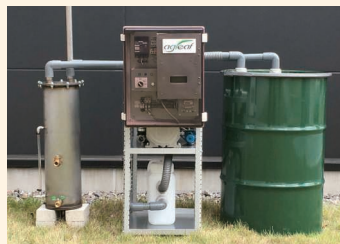
▲農業ハウス栽培用CO 2 貯留・供給装置「agleaf®」
